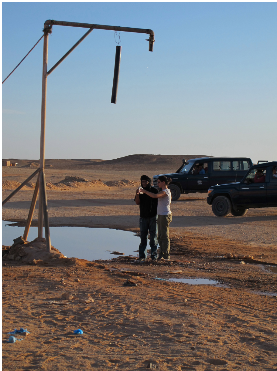
Punto di prelievo da uno dei pozzi artesiani che alimenta l'acquedotto della Wilaya di El Ayun
