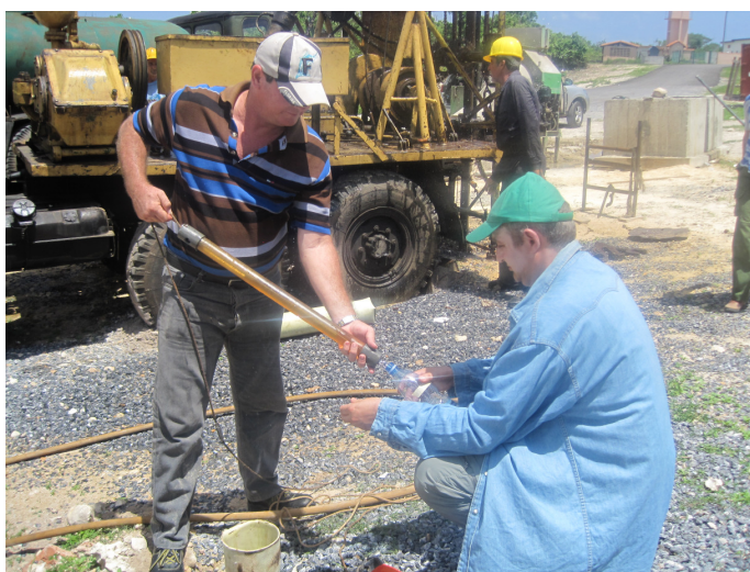
Prelievo di un campione d'acqua in pozzo, da sottoporre a successive analisi chimiche, isotopiche e biomolecolari (da sinistra verso destra: Mario Luis López-Portilla Robaina, Instituto Nacional de Recursos Hidráulicos; Gino Naclerio, Università degli Studi del Molise).
