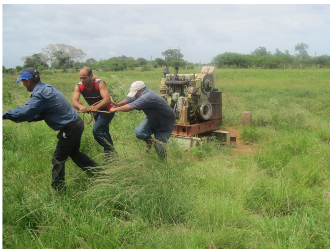
Fasi di accensione di un motore per la messa in funzione di una pompa in un pozzo prescelto per il prelievo di campioni d'acqua.
